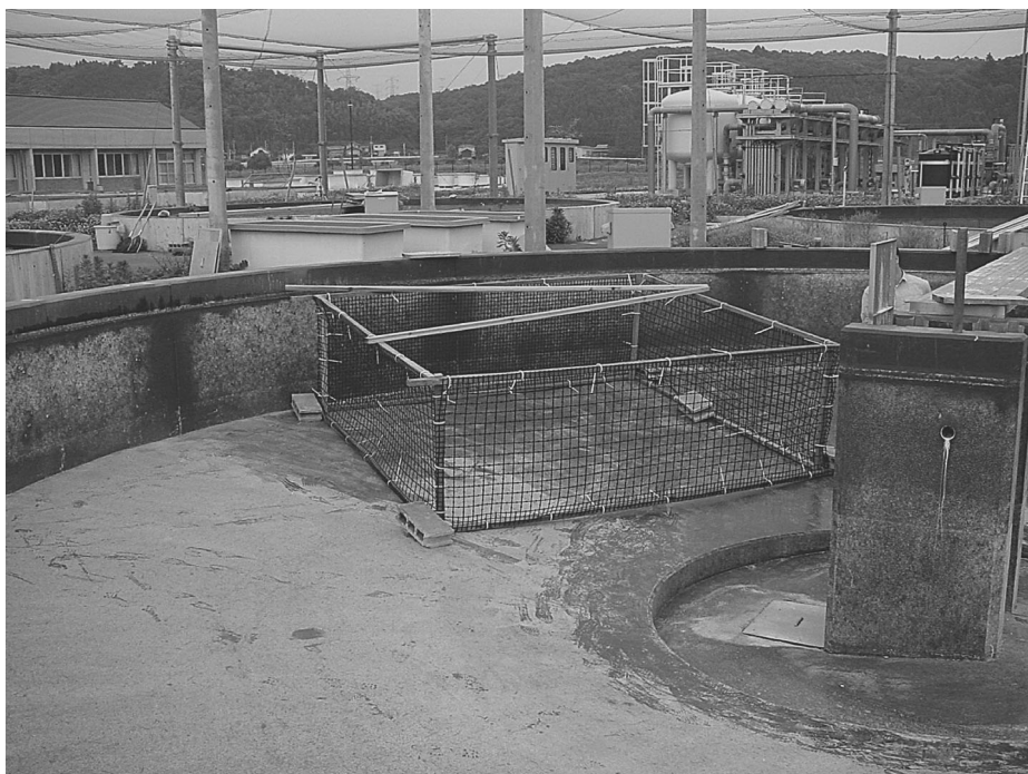
図5.2-17 工事用ネットで作成した障害物
